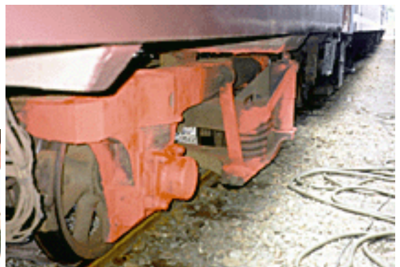
錆び止めスプレーをかけます
