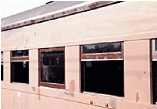
雨樋と窓枠を新品に交換しました。 塗装色の違いにご注目
