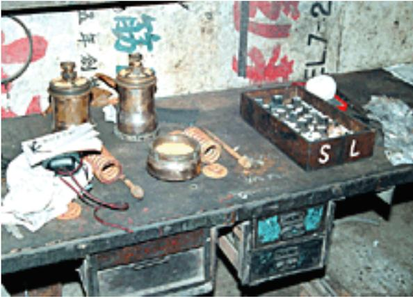
ボイラー検査待ちの安全弁(左)と洗栓・溶栓
