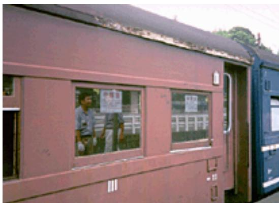
「故障中」と表示された窓枠と新たに崩壊した雨どい（オハニ）
