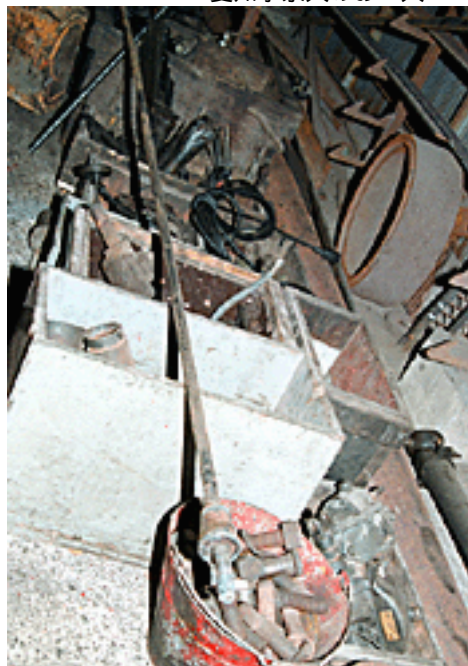
これが、C12の損傷した煙管を塞いでいた栓
