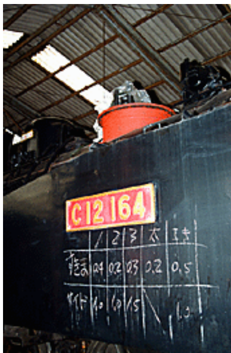
修理を終えた蒸気溜め (下塗りの部分)
