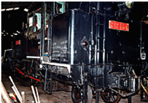
検査工程が書かれたC12の水タンク
