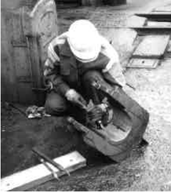
動軸メタルの加修(きさげ)
