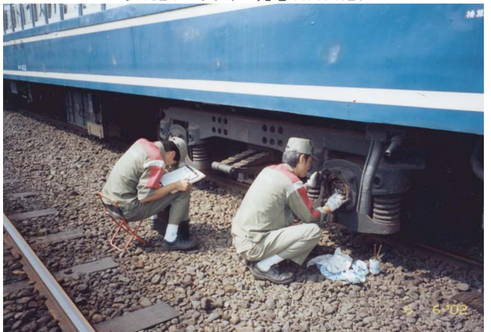
スハフ432の車軸探傷 H14.6.6
