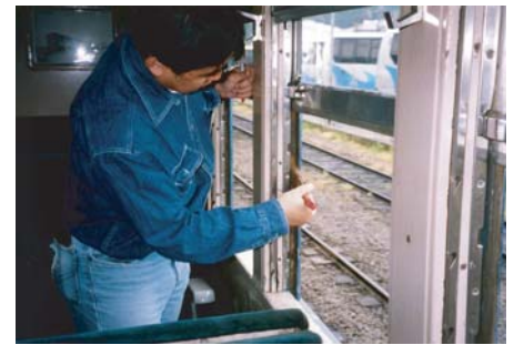
切り抜いたペット紙を2枚のアクリル板に挟み込む。問題は雨などが入り込まないように隙間をどう埋めるかだ。
