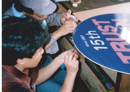
切り抜いたペット紙を2枚のアクリル板に挟み込む。問題は雨などが入り込まないように隙間をどう埋めるかだ。
